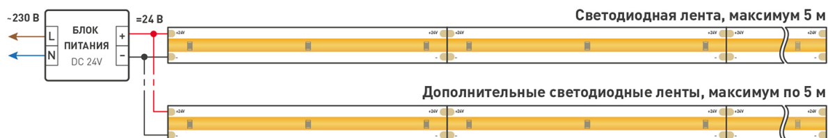
Схема 1. Подключение нескольких светодиодных лент с одной стороны.
